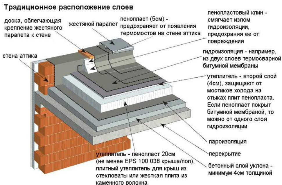
Рисунок 13 – Расположение слоев кровли [15]
